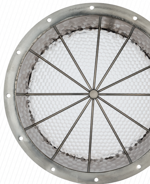
Wilsonova mříž včetně voštinové usměrňovací stěny
